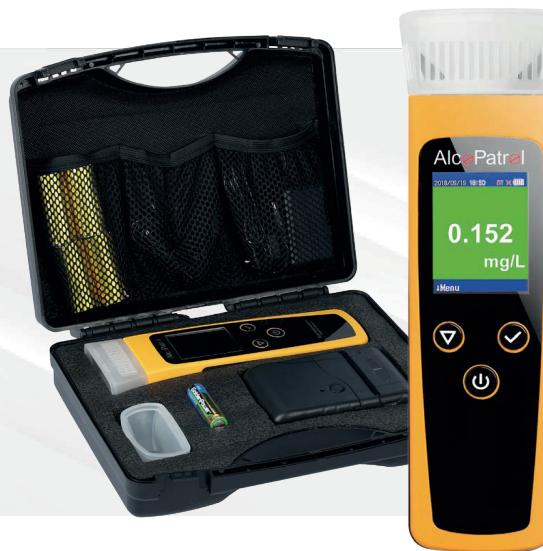
Instrumento de detección rápida de alcohol. Utilizando el modo de prueba de detección rápida, se puede determinar si una persona ha consumido alcohol o no. Utiliza un sensor de célula de combustible que no reacciona con otras sustancias, lo que garantiza la precisión de la prueba.
